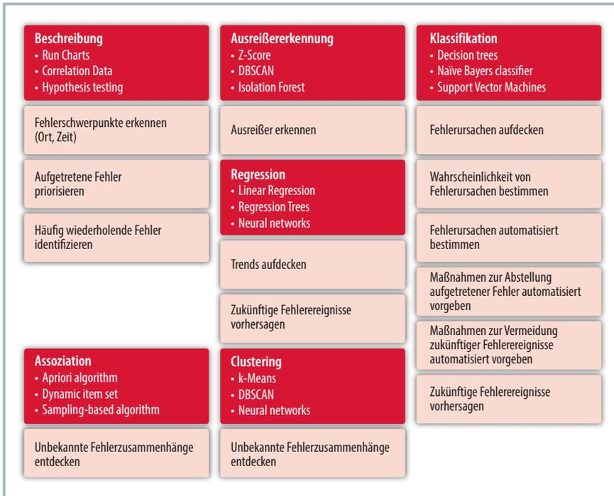
Bild 4. Zuordnung der Analyseziele zu den Analysemodellklassen und beispielhafte Analysemodelle Quelle:
